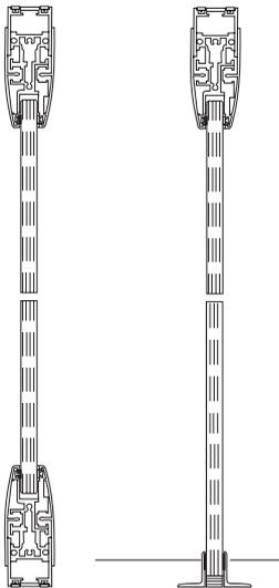
Горизонтальные разрезы откатных и распашных дверей
