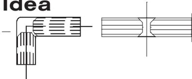
Стандартное сухое соединение двух стеклянных модулей при помощи ПВХ-модулей
